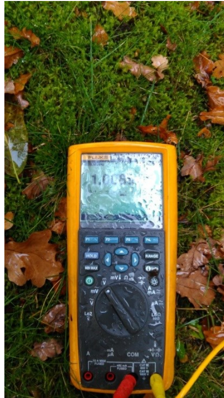
Figur 4.2 Hammarbyhöjden: Potentialmätning, 1 V spänning i marken.
